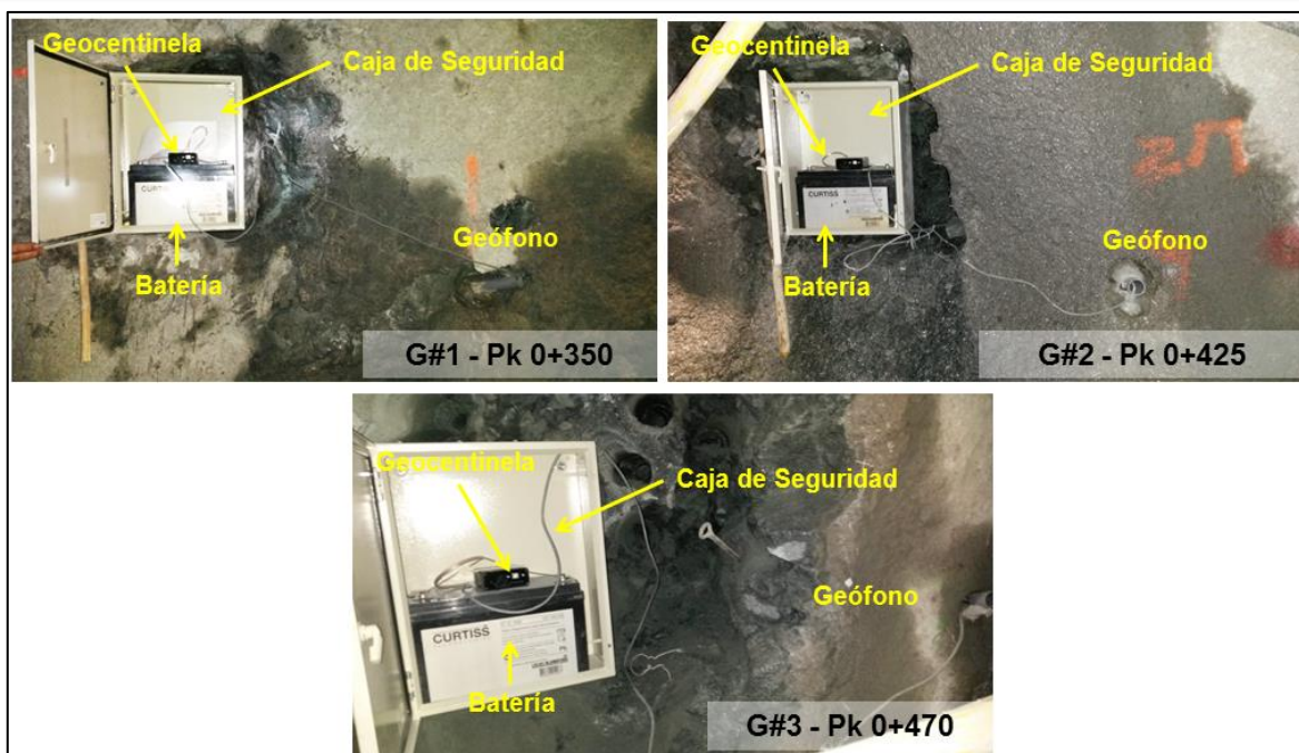
FIGURA 7. INSTALACIÓN DE GEÓFONOS INTERIOR TÚNEL EL VOLCÁN
